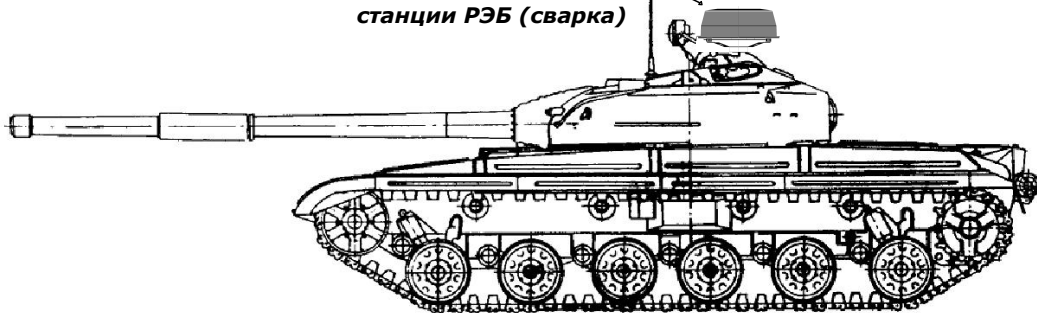
Место установки станции РЭБ (сварка)
